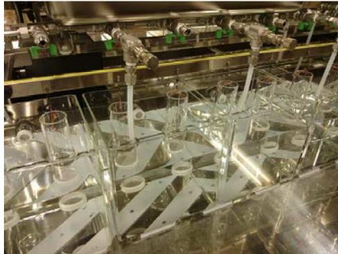
Esta incubadora é constituída por um corpo cilíndrico de vidro (5 cm de diâmetro e 10 cm de altura) e por uma grelha metálica em aço inoxidável (0,25  $\phi$  e 32 mesh), mantida no fundo do corpo cilíndrico com um anel em PTFE. As incubadoras são suspensas por uma barra de movimento vertical sobre as cubas e agitadas verticalmente (aproximadamente 5 cm de amplitude) num ciclo adequado aos ovos de peixe-do-arroz-japonês (aproximadamente uma vez a cada 4 segundos).
