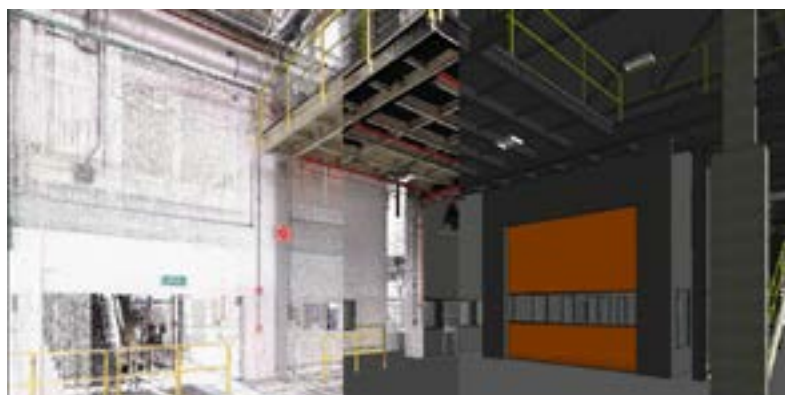
Figura 5.2 Modelo 3 D construído através do varrimento de laser
